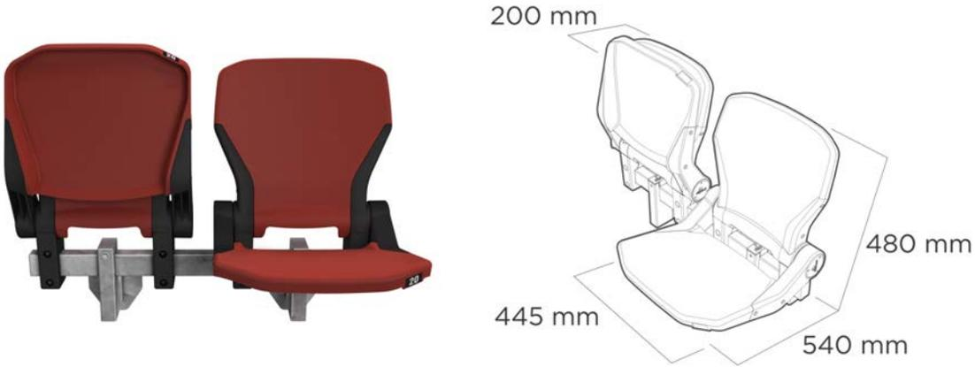
Siège rabattable avec dossier haut, pour des installations sportives de haut niveau ou zone VIP. Système de fixation sur rail qui permet de déplacer latéralement les sièges sur les gradins et d'adapter ainsi la capacité d'accueil selon l'enceinte. La profondeur fermée de 200mm du siège AVATAR permet d'avoir plus d'espace entre rangées.
