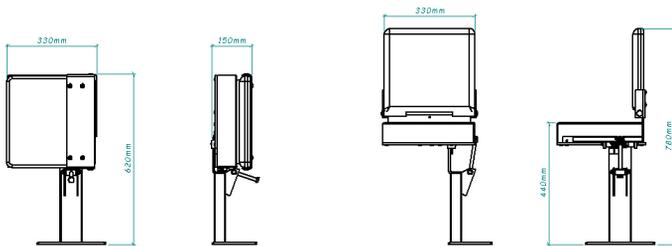
Les strapontins d'allée viennent en continuité des rangées de sièges, leur faible encombrement dans les trois dimensions leur permet de rester conformes aux articles AM18 et L28 relatif à la réglementation des ERP.
